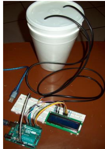
Figura 3. Frontera aislante (con tapas) a través de la cual pasan los dos sensores de temperatura.
