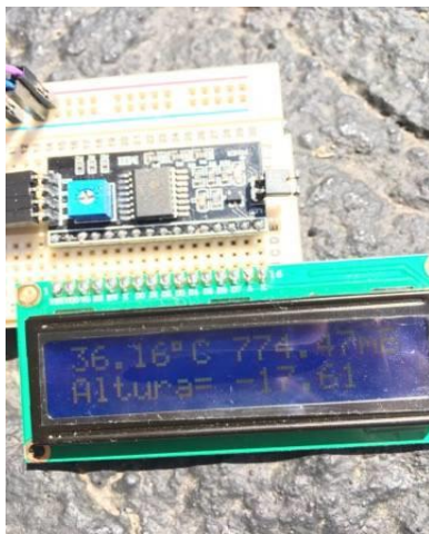
Figura 3. Lectura de la medición de presión en el estacionamiento de profesores. A la izquierda: medición con Arduino UNO. A la derecha: medición con sensor BMP180 y Arduino Nano. Se observa el contraste de las mediciones en la altura principalmente, luego la temperatura y la presión atmosférica.
