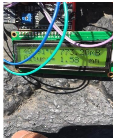
Figura 3. Lectura de la medición de presión en el estacionamiento de profesores. A la izquierda: medición con Arduino UNO. A la derecha: medición con sensor BMP180 y Arduino Nano. Se observa el contraste de las mediciones en la altura principalmente, luego la temperatura y la presión atmosférica.
