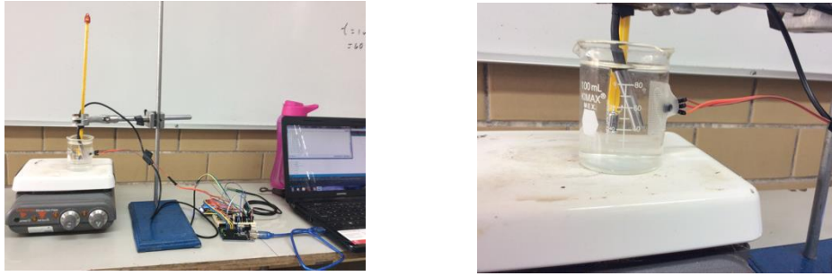
Figura 5. Diseño experimental. Obsérvese la colocación de los sensores y el seguimiento de los datos en tiempo real. Las versiones recientes de Arduino permiten un seguimiento gráfico al momento de la captura de datos de temperatura vs el tiempo.
