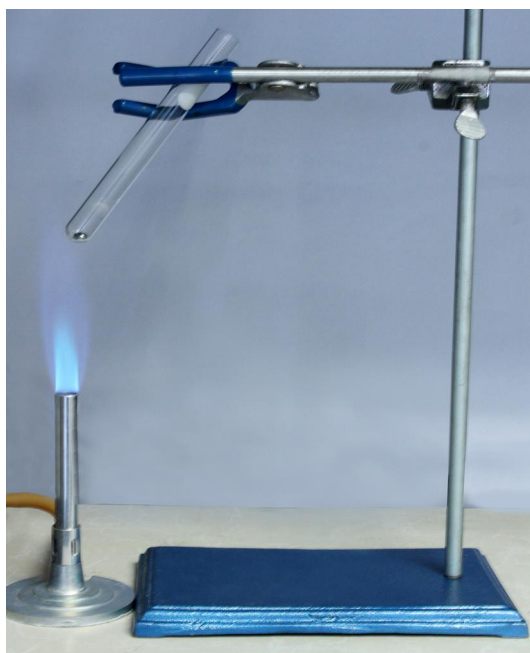
Fig. 17. Montaje para la fusión de sodio. Fotografía de Mayte Castro y Carla Miranda
