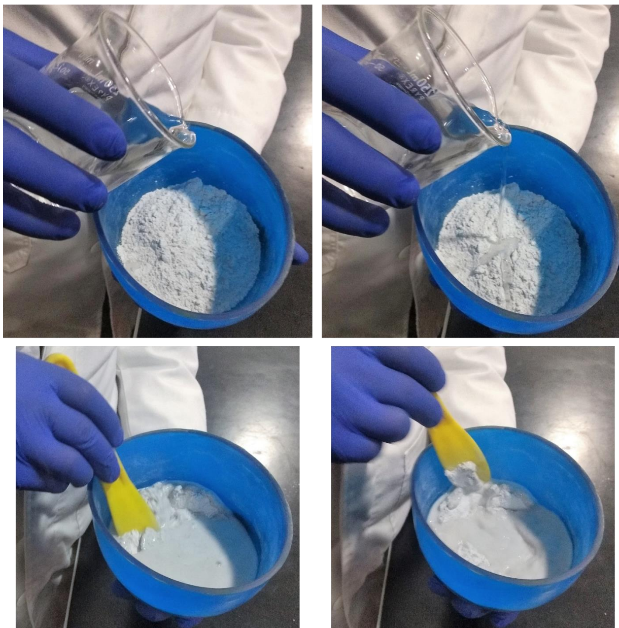
Figura 4 Proceso de hidratación y mezclado del yeso con el agua.
