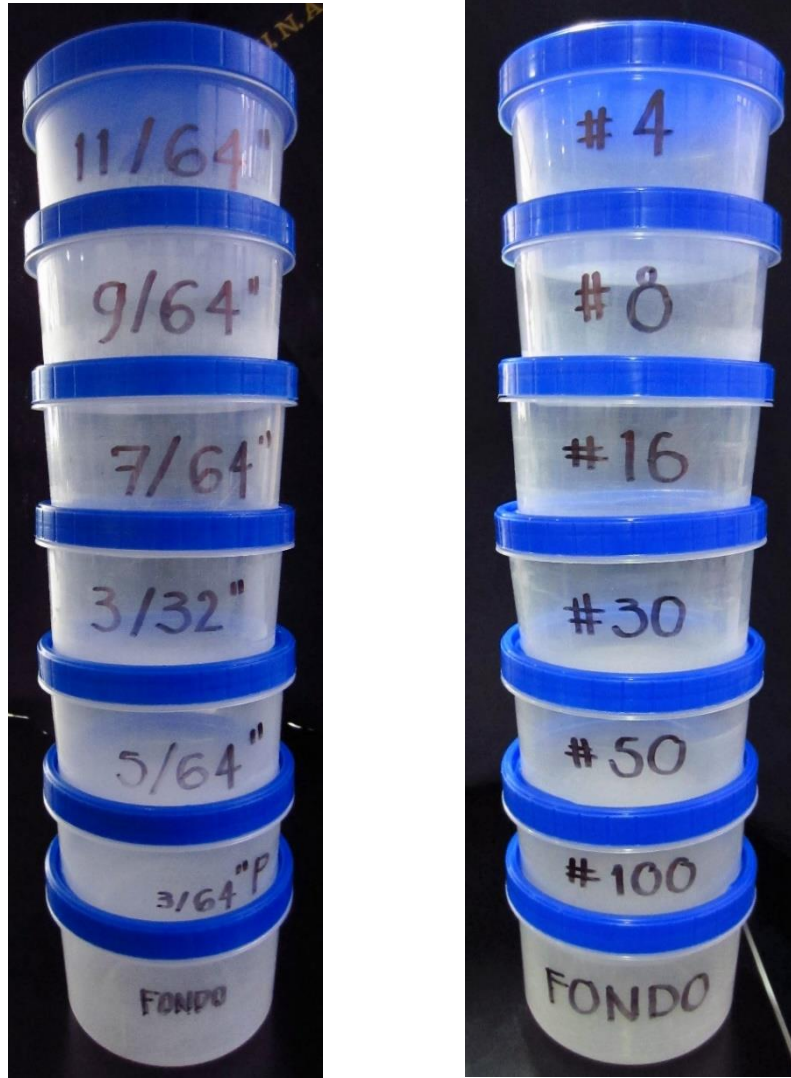
Figura 14 Orden de los recipientes, con relación al diámetro de la perforación.
