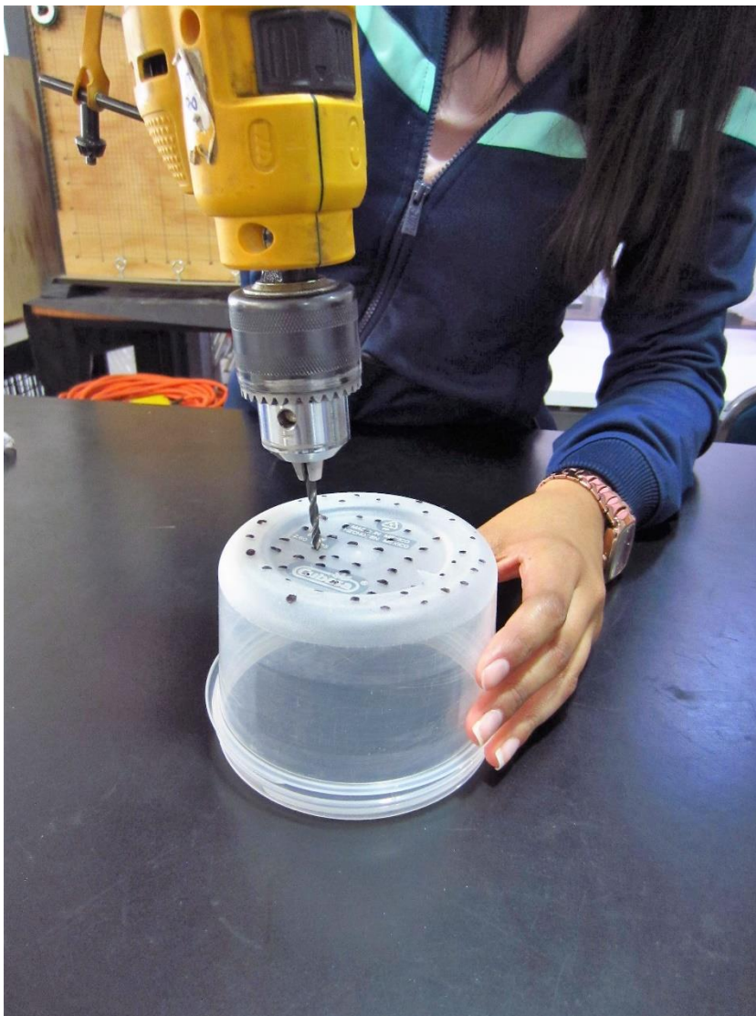
Figura 11 Realización de las perforaciones con ayuda del taladro.
