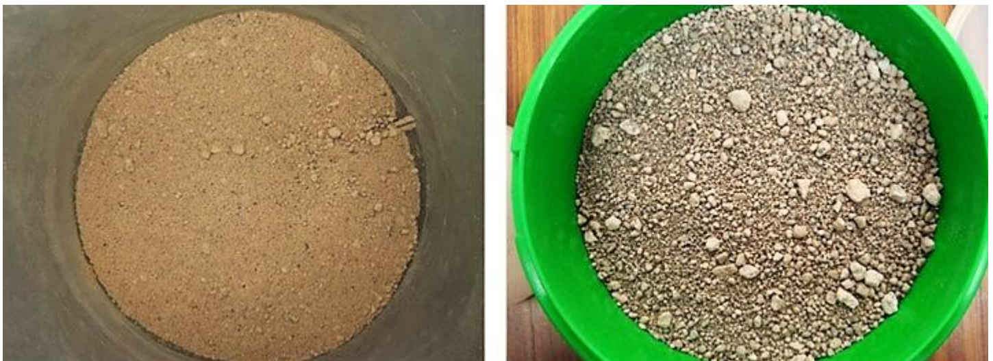
Ilustración 1 Arena rosa con muchos finos (izquierda), Arena rosa correctamente graduada (derecha)
