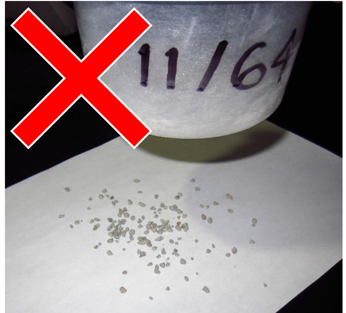
Figura 7 Indica que es necesaria continuar agitando.
