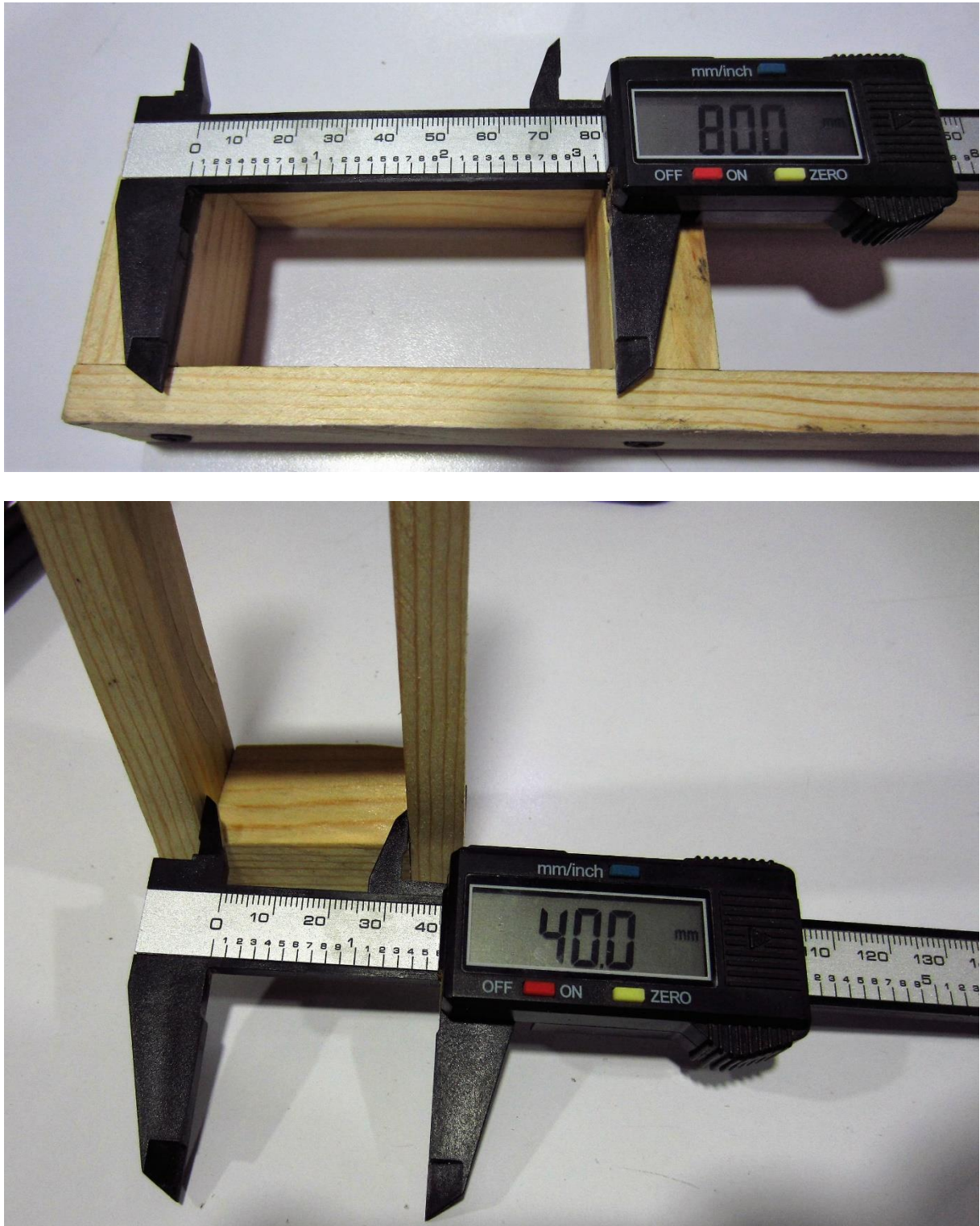
Figura 11 Verificación de las medidas de los moldes.
