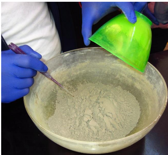
Figura 5 Vaciado del cemento.
