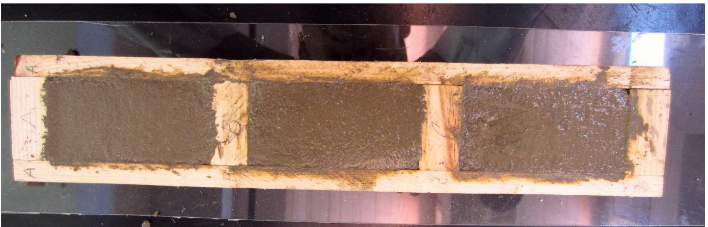
Figura 14 Llenado, varillado y enrazado de los moldes faltantes.
