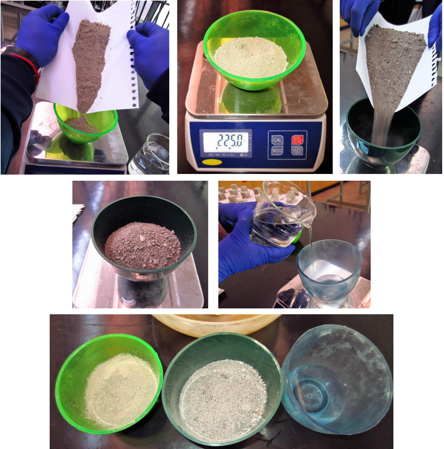
Figura 4 Pesado del cemento, arena y agua.
