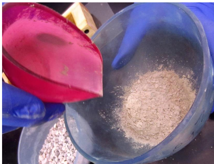
Figura 8 Vaciado del cemento.
