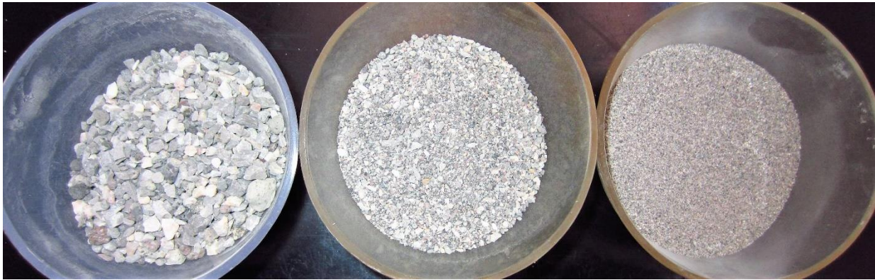
Figura 5 Contenedores con arena gruesa, arena media y arena fina.
