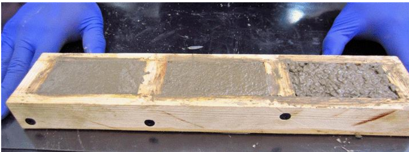
Figura 17 Resultado final de los morteros utilizando la arena gruesa, media y fina.
