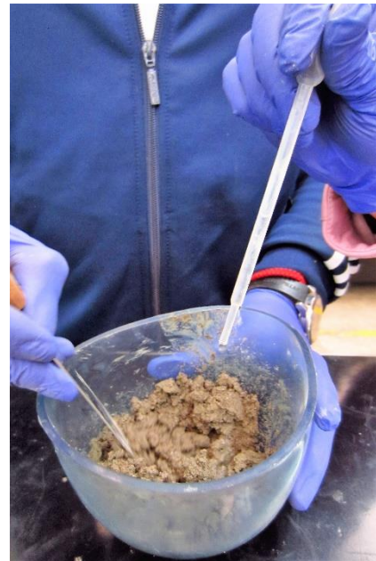
Figura 15 Proceso de hidratación del cemento, adición de arena fina y mezclado.
