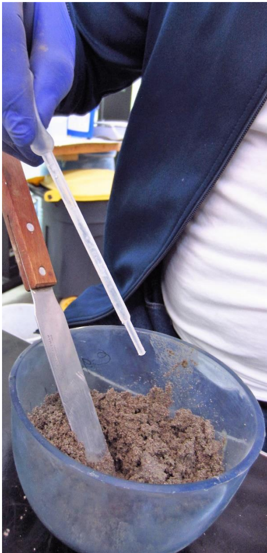
Figura 15 Proceso de hidratación del cemento, adición de arena fina y mezclado.
