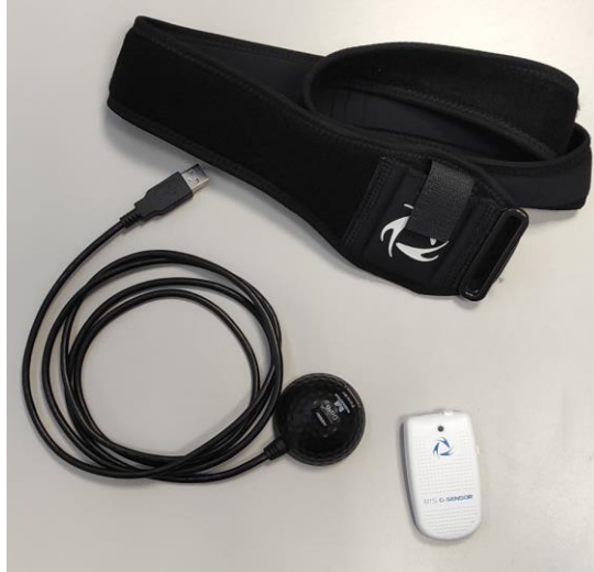
Fig. 4. Sensor inercial G-Sensor, cable y antena Bluetooth y cinturón para la colocación del dispositivo en la anatomía del paciente.
