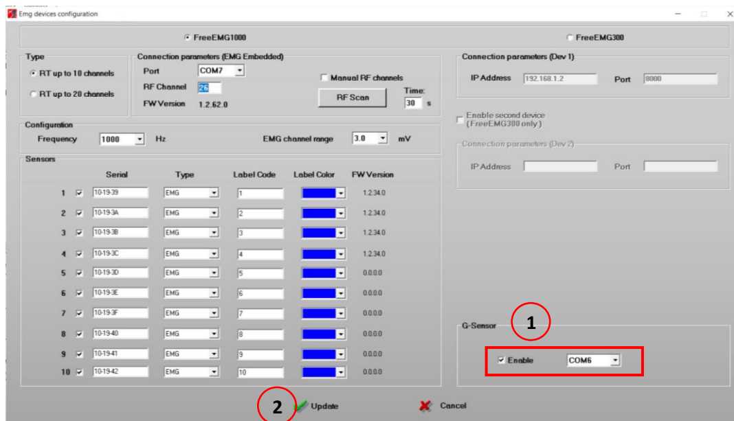
Fig. 10. Ventana para la activación del sensor inercial. Rectificar que el puerto sea el asignado por el sistema. Antes de cerrar, se debe actualizar para que se conecte el sensor inercial.
