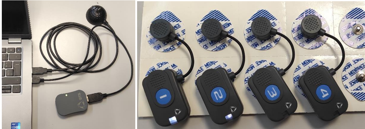
Fig. 8. Conexión del FreeEMG al puerto de la computadora y encendido de las sondas electromiográficas.
