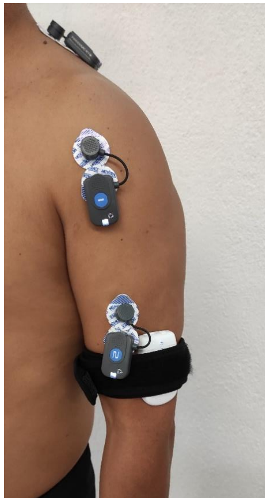
Fig. 16. Colocación de electrodos y sensor inercial en la extremidad izquierda, para la prueba de flexión. Sonda E1 en el Deltoides anterior.
