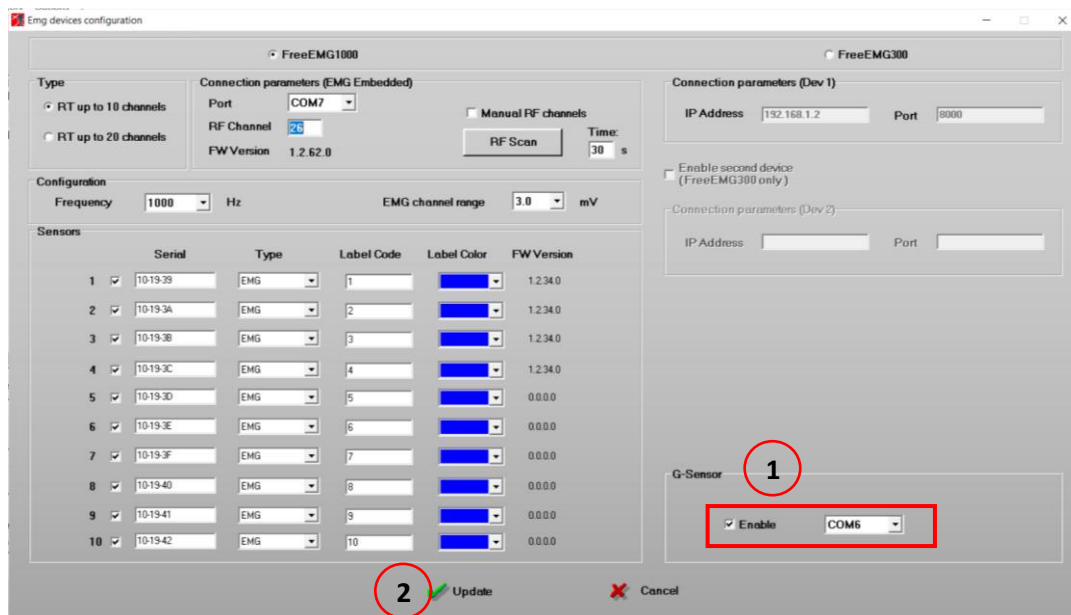
Fig. 7. Ventana para la activación del sensor inercial. Rectificar que el puerto sea el asignado por el sistema. Antes de cerrar, se debe actualizar para que se conecte el sensor inercial.
