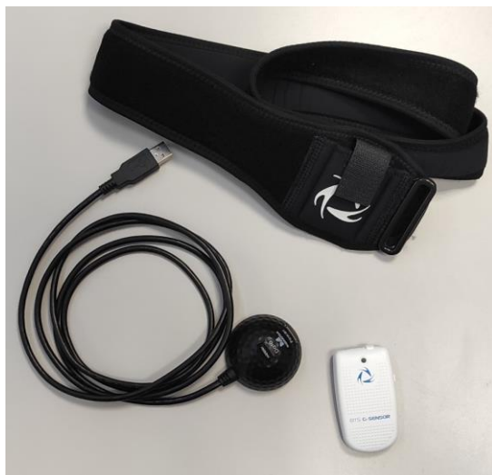
Fig. 2. Sensor inercial G-Sensor, cable y antena Bluetooth y cinturón para la colocación del dispositivo en la anatomía del paciente.
