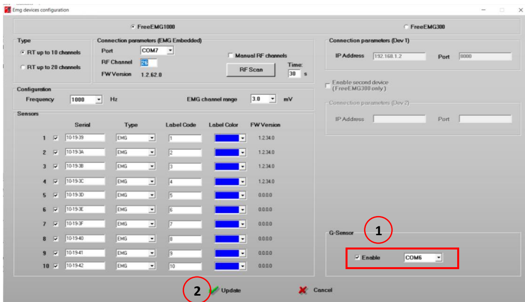
Fig. 9. Ventana para la activación del sensor inercial. Rectificar que el puerto sea el asignado por el sistema. Antes de cerrar, se debe actualizar para que se conecte el sensor inercial.
