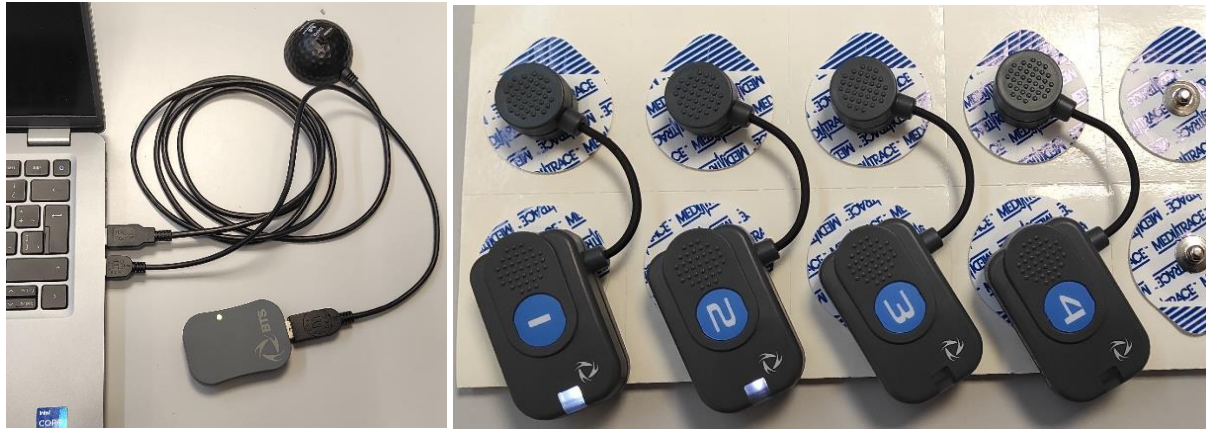
Fig. 7. Conexión del FreeEMG al puerto de la computadora y encendido de las sondas electromiográficas.
