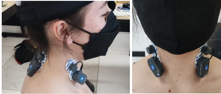
Fig. 17. La separación entre los electrodos de la parte madre y satelital debe ser entre 2 a 3 cm. Músculos esternocleidomastoideo derecho e izquierdo.
