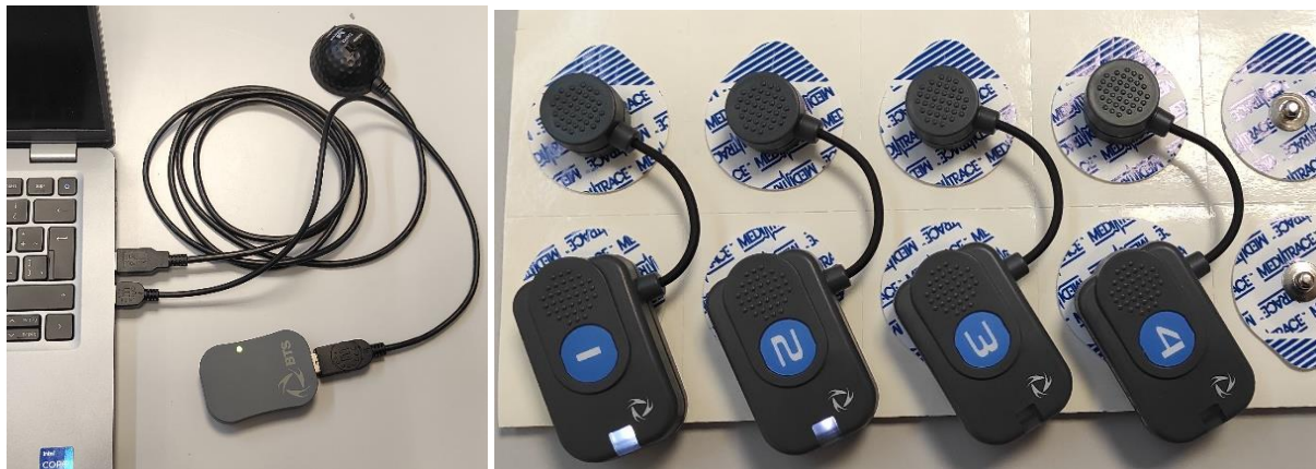
Fig. 6. Conexión del FreeEMG al puerto de la computadora y encendido de las sondas electromiográficas.
