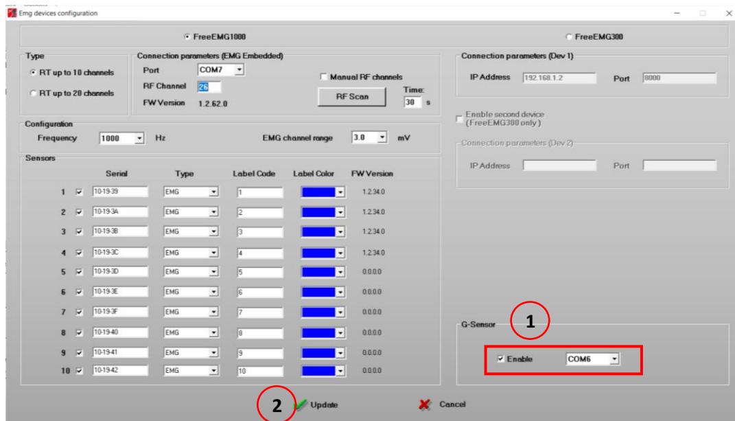
Fig. 8. Ventana para la activación del sensor inercial. Rectificar que el puerto sea el asignado por el sistema. Antes de cerrar, se debe actualizar para que se conecte el sensor inercial.
