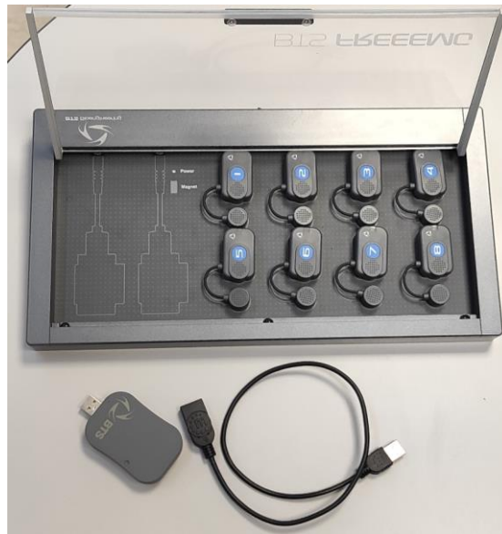
Fig. 4. Equipamiento para el análisis de la postura estática: sondas electromiográficas FreeEMG en su estación de carga, antena USB y cable de extensión.
