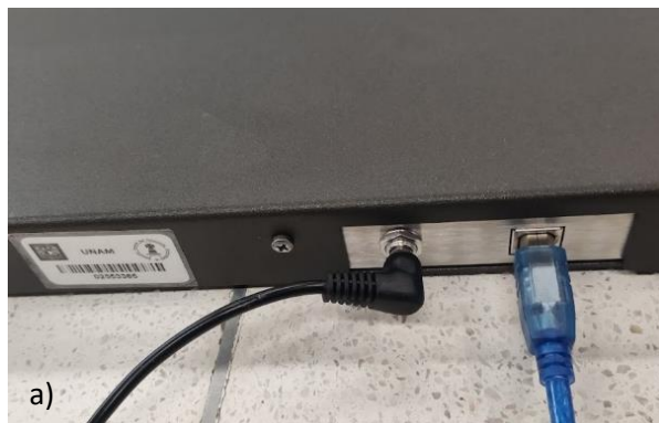
Fig. 5. Conexión de la plataforma a la corriente y al puesto USB de la computadora.
