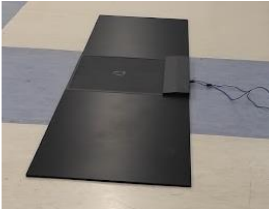
Fig. 5. Plataforma baropodométrica del sistema P-Walk.
