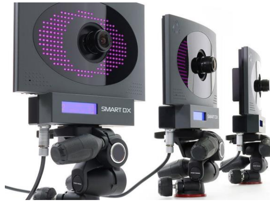
Fig. 2. Sistemas optoelectrónicos de alta precisión para el análisis de movimiento.
