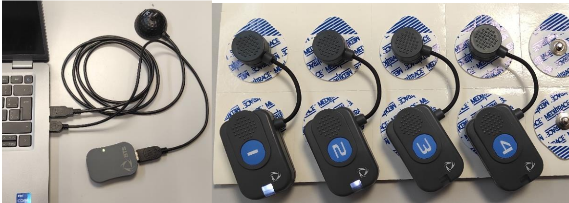
Fig. 10. Conexión del FreeEMG al puerto de la computadora y encendido de las sondas electromiográficas.
