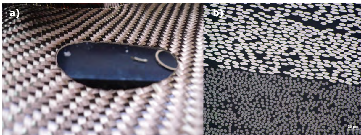
Figura 4.1. Ejemplo de fibra de carbono. a) Stfnix. Lasersaur, carbon fiber test . Licenciado bajo CC BY-NC-SA 2.0. b) ZEISS Microscopy. Brightfield microscopy of carbon fiber-reinforced plastic (CFRP) . Licenciado bajo CC BY-NC-ND 2.0.
