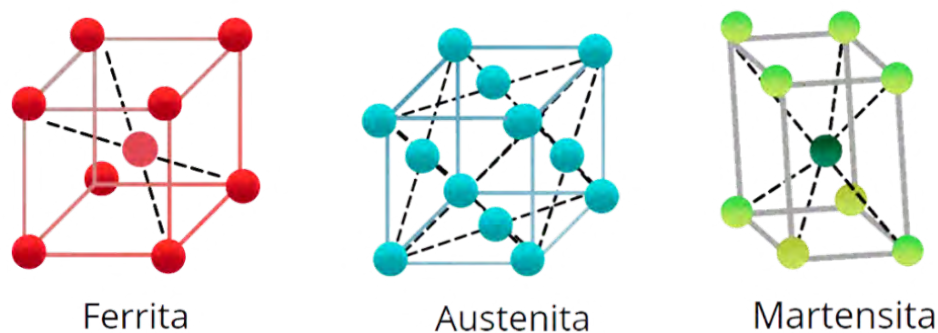
Figura 1.8. Estructura cristalina de los materiales: ferrita (BCC), austenita (FCC) y martensita.
