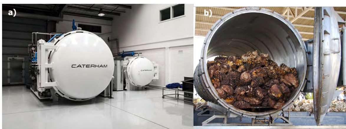
Figura 4.3. a) Máquina para autoclave y b) ejemplo de proceso utilizando agave. a) CaterhamF1. 12 Composites Part Cure–Autoclave . Licenciado bajo CC BY-NC-ND 2.0. b) Bbum. Autoclave with Roasted Agave . Licenciado bajo CC BY-NC-ND 2.0.
