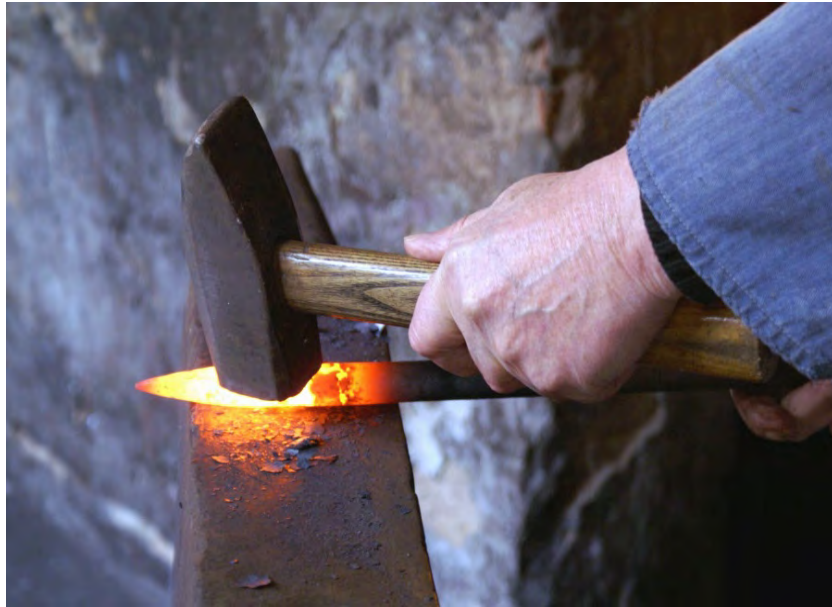
Figura 1.1. Proceso de forja abierta. Creative Commons. Licenciado bajo CC0 1.0.
