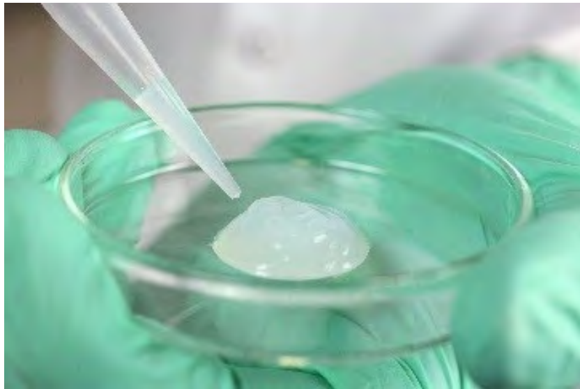
Figura 2.3. Hidrogel de nanocelulosa. Qspheroid4. (2016). Hidrogel de celulosa nanofibrilar . Licenciado bajo CC-BY-SA-4.0.
