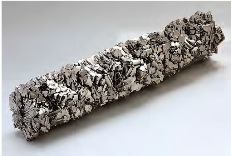
Figura 1.12. Barra de titanio puro. Alquimista-hp. (2009). Titan-crystal bar . Wikimedia Commons.
