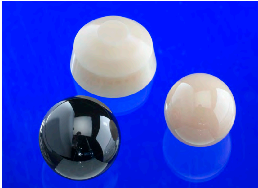
Figura 1.18. Una de las aplicaciones más comunes de la zircona es la que se utiliza para la fabricación de cabezas femorales en las prótesis de cadera. Smith and Nephew Orthopaedics. Femoral head used in hip replacements (femoral head; artificial hip joint). Licenciado bajo CC BY-NC-SA 4.0.
