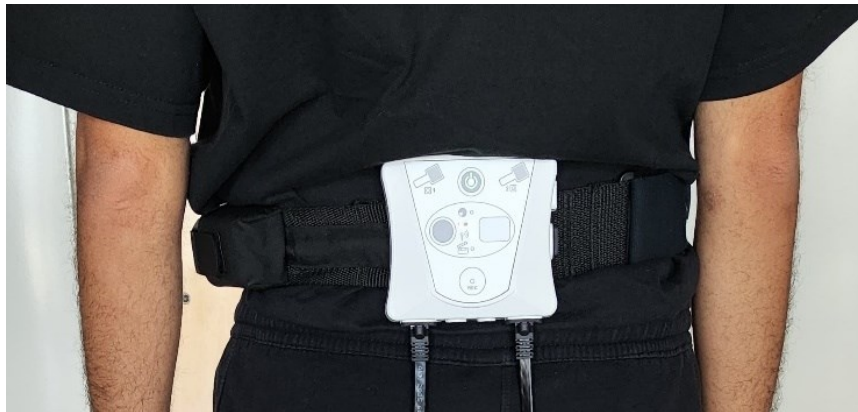
Fig. 57 Colocación de la Unidad central (versaTek Hub, Tekscan, Boston, MA, USA) en la parte posterior de la región lumbosacra. Fuente: Elaboración propia. Con permiso escrito de uso de imágenes.
