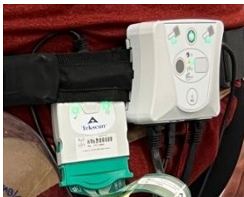
Fig. 92 Colocación de la Unidad central (versaTek Hub, Tekscan, Boston, MA, USA) en la parte posterior de la región lumbosacra. Fuente: Elaboración propia. Con permiso escrito de uso de imágenes.
