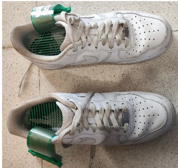
Fig. 55 Colocación de los sensores de presión dentro del calzado, sin ondulaciones o arrugas. Fuente: elaboración propia. Con permiso escrito de uso de imágenes.
