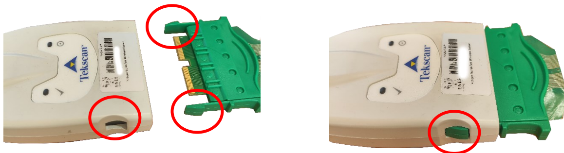
Fig. 44. Conexión de los sensores con las terminales (Versatek Cuffs, Tekscan, Boston, MA, USA). Fuente: Elaboración propia. Permiso escrito de uso de imágenes.
