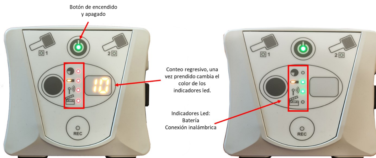
Fig. 47. Señalización del estado de la unidad principal (Versatek Hub, Tekscan, Boston, MA, USA). Los dos indicadores led del medio deberán estar en verde indicando que la batería está cargada y la conexión al Router se realizó de forma satisfactoria. Fuente: Elaboración propia. Permiso escrito de uso de imágenes.
