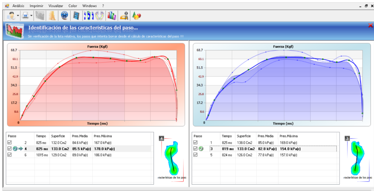
Fig. 40. Gráfico de la fuerza de reacción vertical respecto al tiempo y área debajo de la curva Fuente: imagen de un reporte del software G-Studio (BTS Bioengineering, Milán, Italia). Permiso escrito de uso de imágenes.
