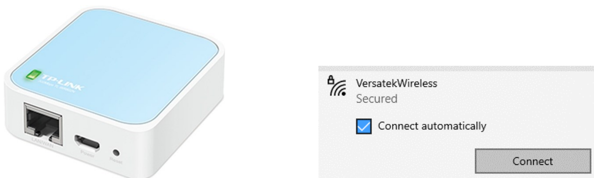
Fig. 45. Nano-Router que crea la red inalámbrica “VersatekWireless” para la transmisión de datos del sistema VersaTek (Tekscan, Boston, MA, USA) a la computadora. Fuente: Elaboración propia.
