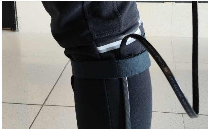
Fig. 58 Colocación de la cinta de posicionamiento de los cables RJ45 en el extremo proximal de la tibia, ligeramente por debajo de las mesetas tibiales. Fuente: Elaboración propia. Con permiso escrito de uso de imágenes.
