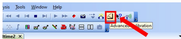
Fig. 86. Opciones para iniciar la calibración de los sensores, a) ícono para iniciar una nueva grabación, b) Menú de Herramientas para la calibración de los sensores, c) ícono de la barra de herramientas para iniciar la calibración. Fuente: Captura de pantalla del software F-Scan Clinical (Tekscan, Boston, MA, USA). Permiso escrito de uso de imágenes.
