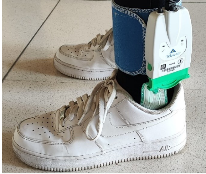
Fig. 56 Colocación de la cinta velcro y fijación de las terminales (VersaTek Cuffs, Tekscan, Boston, MA, USA) en el extremo distal de la tibia, ligeramente superior a los maleolos. Fuente: Elaboración propia. Con permiso escrito de uso de imágenes.
