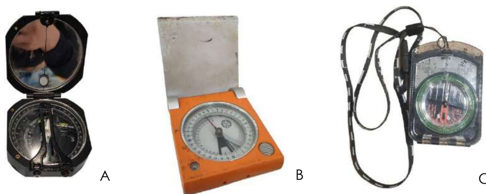
Figura 69. Tipos de brújulas utilizadas para la medición de estructuras geológicas, A: tipo Brunton, B: tipo Freiburger o estructural y C: tipo Silva (Fotografías de brújulas tomadas por Edna López, septiembre 2022).
