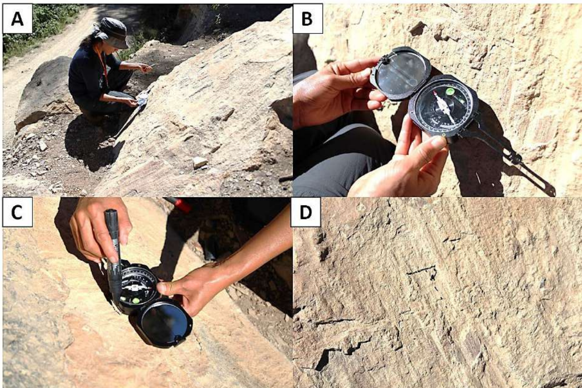
Figura 40. Pasos para medir el rumbo y buzamiento del plano de falla y el pitch de las estrías contenidas en el plano de falla (Fotografías tomadas por Rosario Vázquez, camino hacia El Suspiro, Qro., noviembre 2020).
