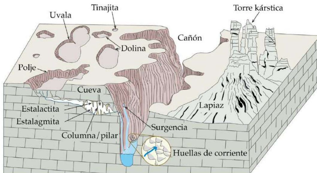
Figura 54. Diagrama esquemático donde se muestran algunas formas de karst superficial (exokarst) y subterráneo (endokarst) (elaborado por Berlaïne Ortega, diciembre 2022, modificado de Huggett, 2011).
