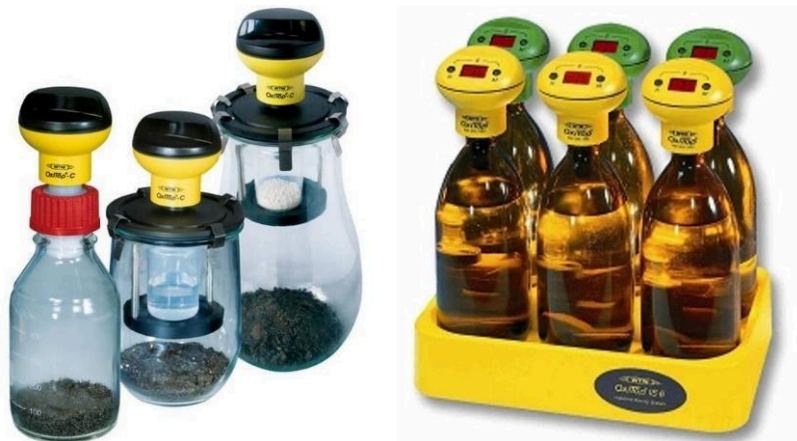
Figura 5. Manual de operación del OxiTop®. 2024. Imagen. Contenedores para medir respiración de suelo (izquierda) y contenedores para medir DQO en agua (derecha).
