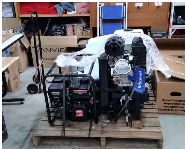
Figura 5. Izquierda, ejemplo de un motor para bombeo, derecha, ejemplo de un motor a gasolina para perforación.
