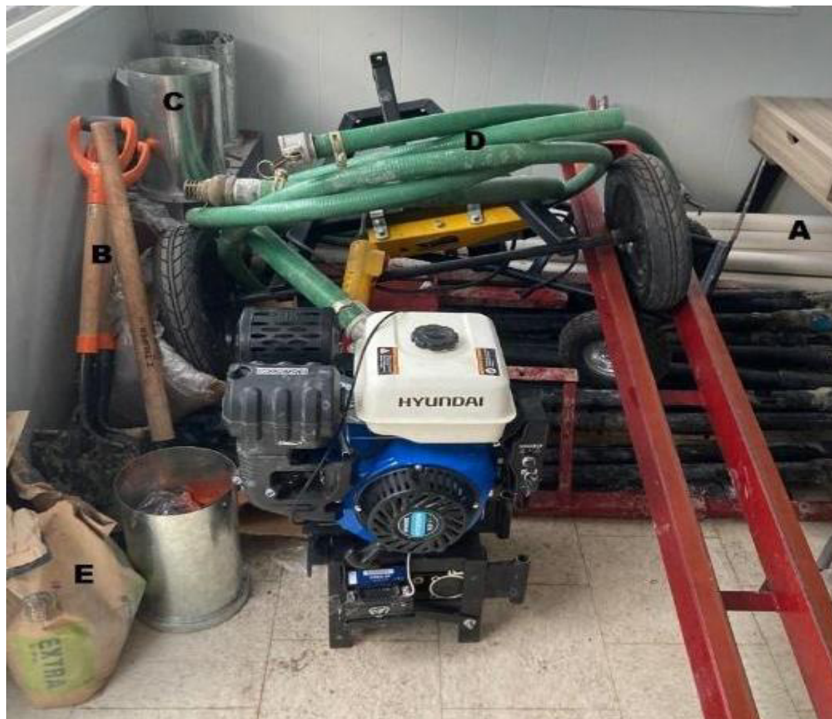
Figura 13 Material necesario para la construcción de piezómetros A) Tubería de PVC de 2 pulgada de 1.5 m de largo, B) Palas y picos, C) Nucleadoras, D) Manguera, E) Cemento.
