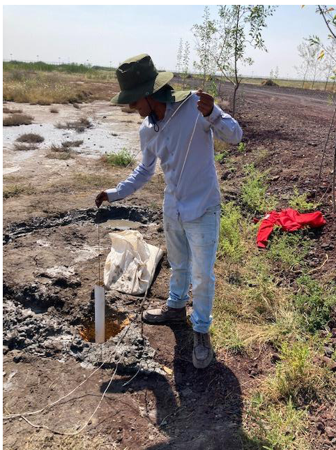
Figura 33. Limpieza del interior del tubo de PVC con equipo bailer. A) introducción del bailer dentro del tubo de PVC. B) Extracción del lodo de perforación.
