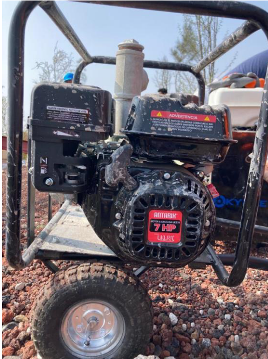
Figura 7. Ejemplo de una Motobomba de la marca Antarix previa a su instalación.
