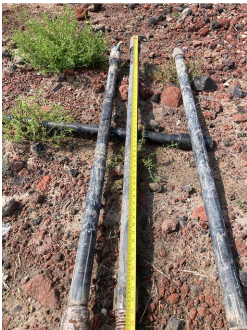
Figura 10. Lingadas o secciones de la tubería de perforación
