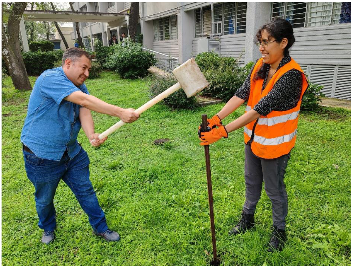
Figura 10. Proceso de hincado de una barrena por el método de percusión
