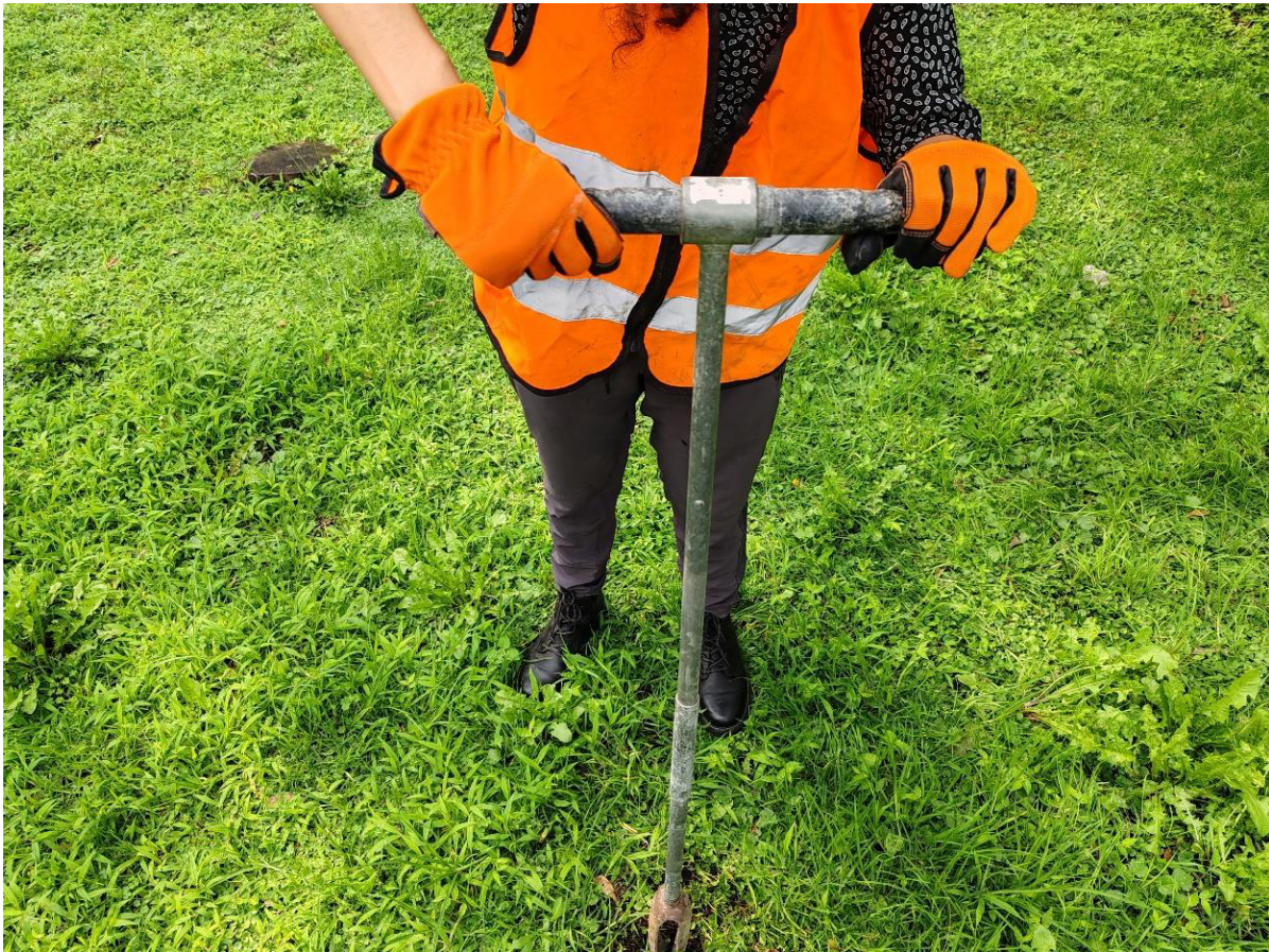
Figura 14. Perforación con método rotativo.
