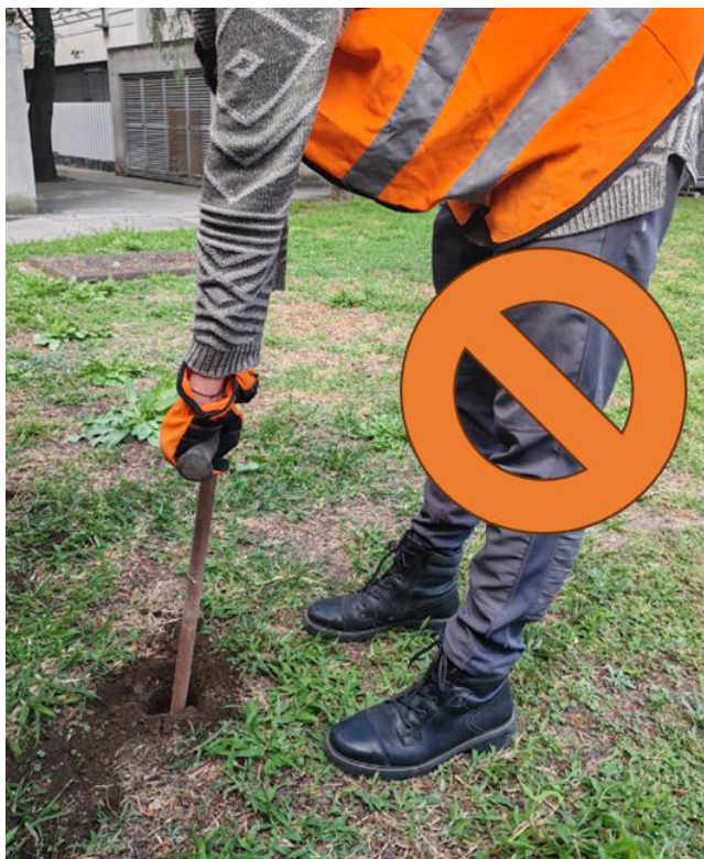
Figura 11. Posición incorrecta para levantar la barrena.
