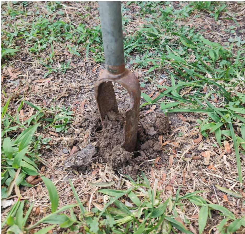
Figura 16. Embocadura del suelo dentro de la barrena posterior a un primer giro.
