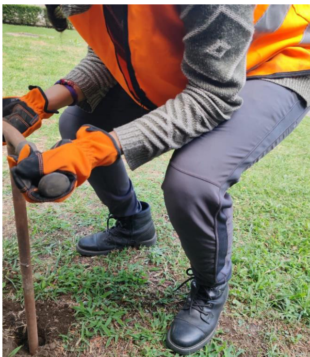
Figura 12. Posición correcta para levantar la barrena.
