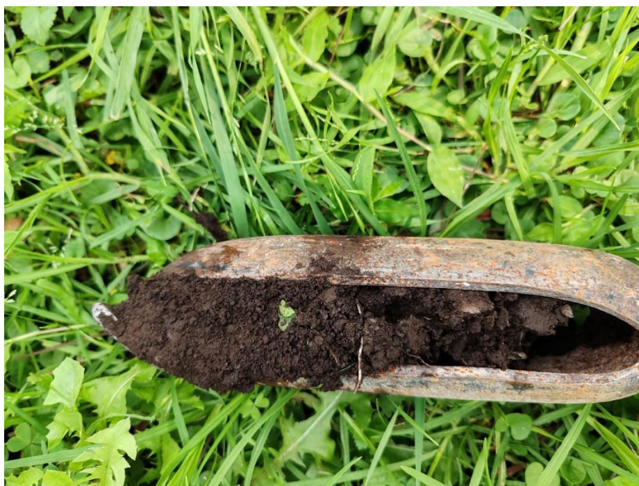
Figura 17. Recuperación de suelo con la barrena de barril.
