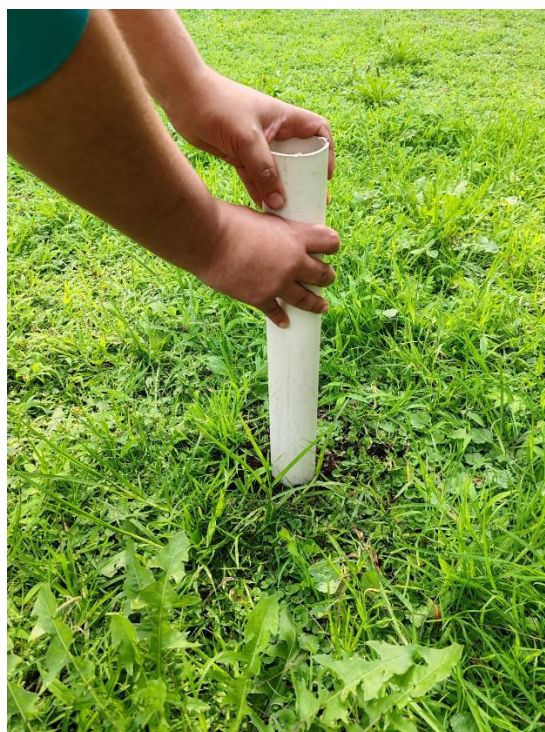
Figura 26. Tubería de PVC completamente hincada
