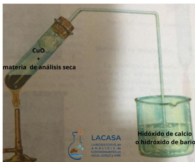
Figura 1 Esquema del procedimiento experimental para la identificación de carbono e hidrógeno. Adaptado de Química orgánica (2.ª ed.), por G. Devoré y E. Muñoz Mena, 1969, Publicaciones Cultura
