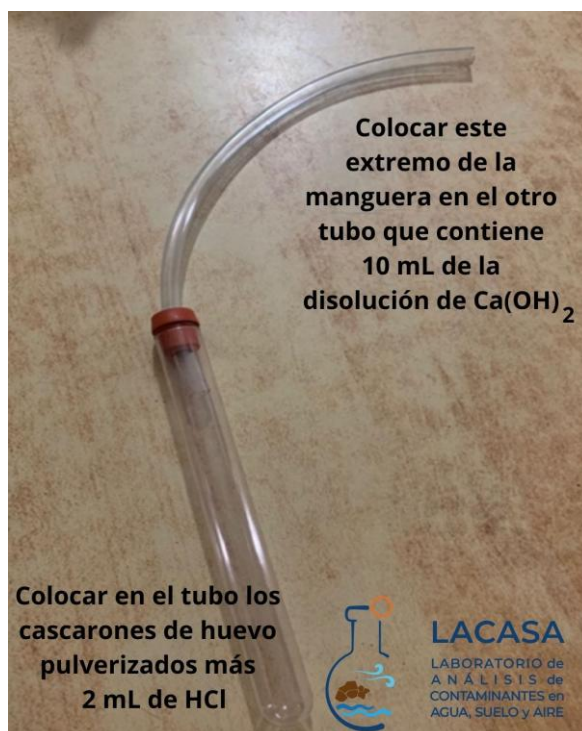
Figura 2 Sistema de trampa de gases
