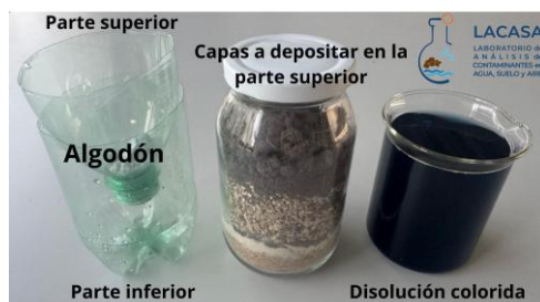
Figura 2 Sistema de filtración realizado con materiales accesibles
