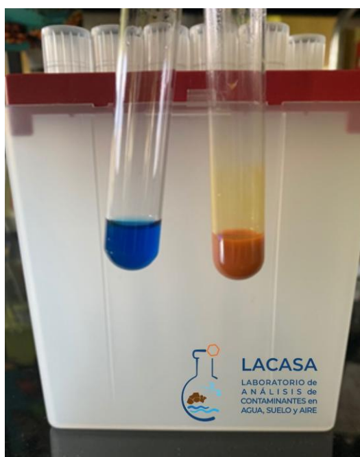
Figura 1 Prueba de Fehling para la identificación de un azúcar reductor
