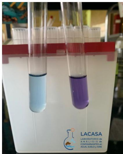
Figura 2 Prueba de Biuret para la identificación de proteínas
