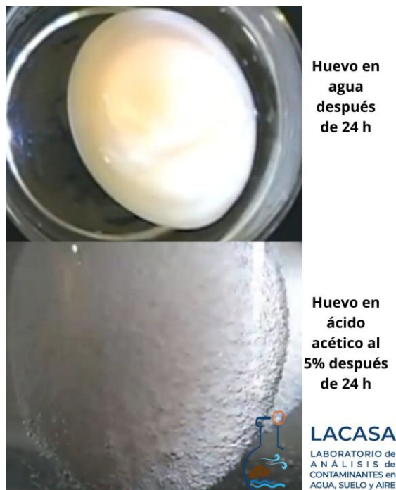
Figura 1 Simulación de intemperismo químico en carbonato de calcio
