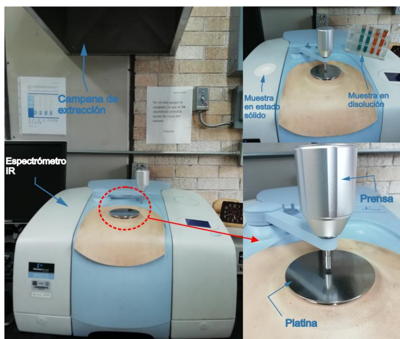
Figura 1. Espectrofotómetro FTIR con ATR de punta de diamante (PerkinElmer Spectrum 100 FT-IR and FT-IR spectrometers. Estados Unidos de América: PerkinElmer, 2005).
