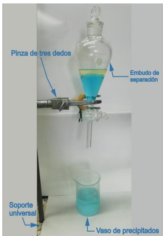
Figura 3. Sistema para separación de fases empleando embudo de separación.
